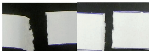
8. ábra Szakadási különbségek a Canon I. mintánál (balra: kereszt irányban, jobbra: szál irányban)
