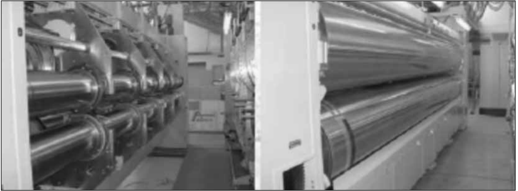
4. ábra. Hornyoló és rotációs kivágó egység a BGM Containerline berendezéshez
