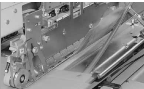
1. ábra. Starfold hajtogató-ragasztógép – doboz oldallapjának felállítása vezető mentén
