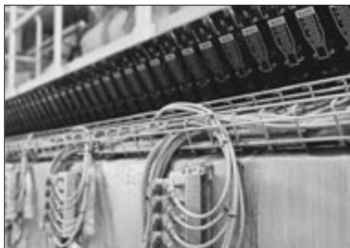
3. kép. A Voith Paper Automation az OnQ ModuleTap segítségével egy olyan új működtetőt tud ajánlani, amelyet forgó fejes (golyó-csapos) hígítóvíz-szelepes felfutó-szekrényeknél lehet használni.
