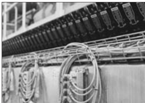
3 kép. A Voith Paper Automation az OnQ ModuleTap segítségével egy olyan új működtetőt tud ajánlani, amelyet forgó fejes (golyó-csapos) hígítóvíz-szelepes felfutó-szkevényeknél lehet használni.
