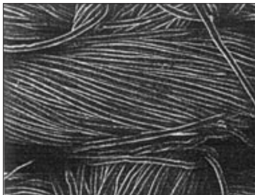
9. ábra Szótt lyocell kelme megjelenése fibrilláció előtt
