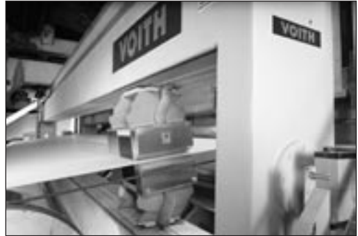
2 kép. A szemináriumon résztvevők meggyőződhetnek, hogy a moduláris felépítésű, karbantartást nem igénylő gépbe épített OnQ Scanner egy vonalban lévő érzékelő fejeit 30 másodperc alatt ki lehet cserélni.
