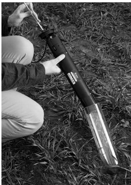
1. kép • A CI-600 típusú gyökérszkenner és a talajba helyezett mérőtubus
