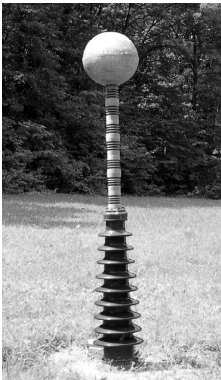
1. ábra • Gömbantenna a Schumann-rezonanciák mérésére a Széchenyi István Geofizikai Observatóriumban (MTA GGKI)
