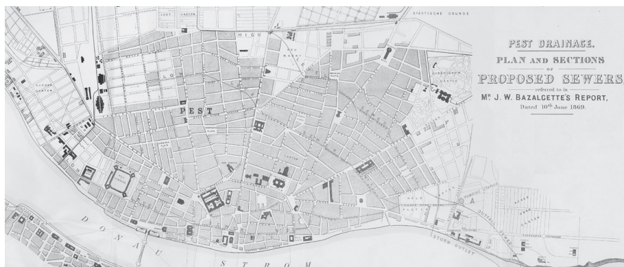
1. kép. Bazalgette 1869-es csatornarendszer-tervezetének részlete
