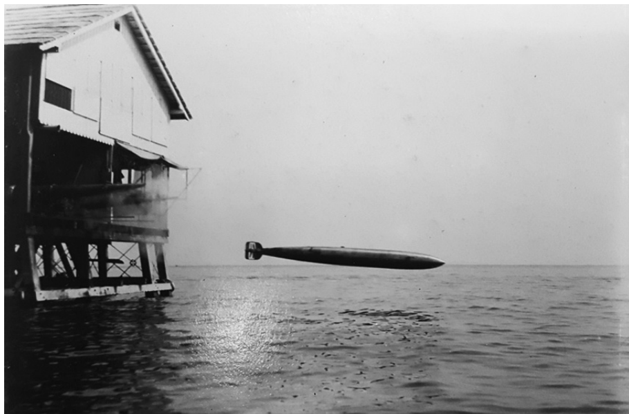
1. kép. Lanszírozó kísérlet a fumei torpedógyárban
