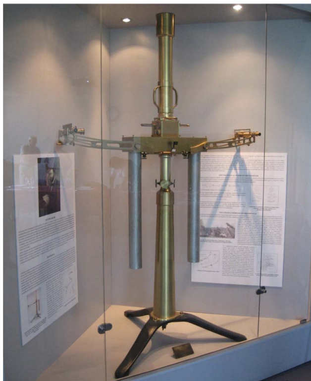
4. ábra. A kettős Eötvös-inga eredeti, első példánya a Miskolci Egyetemen, 2010.
