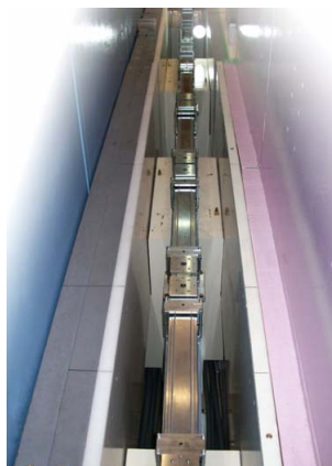
2. ábra. A Mirrotron Kft. által készített neutronvezető az Oxford melletti ISIS neutronkutató központban.
