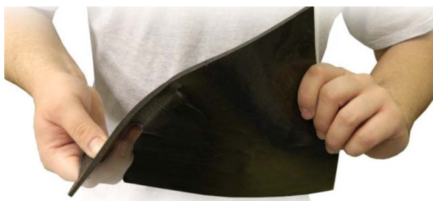
10. ábra. MirroBor márkanevű rugalmas neutronvédő anyag.
