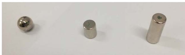
4. ábra. A mérés során használt mágnesestestek.
