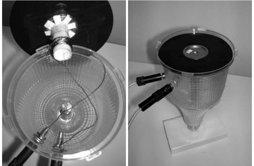
2. ábra. Napelemes lámpából készült hangszóró.
