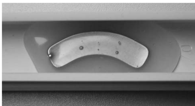
10. ábra. A sínbe ragasztott tartómágnes.
