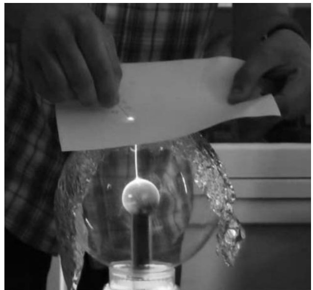
3. kép. Plazmagömbre alufólia, szigetelő és tüvel kisülés.
