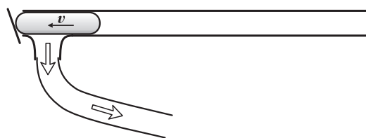
5. ábra. A porszívós ágyú működése, fölül porszívó bekapcsolása, cső lezárása, lövedék behelyezés, alul a kilövés a megfelelő vákuum elérése után.
