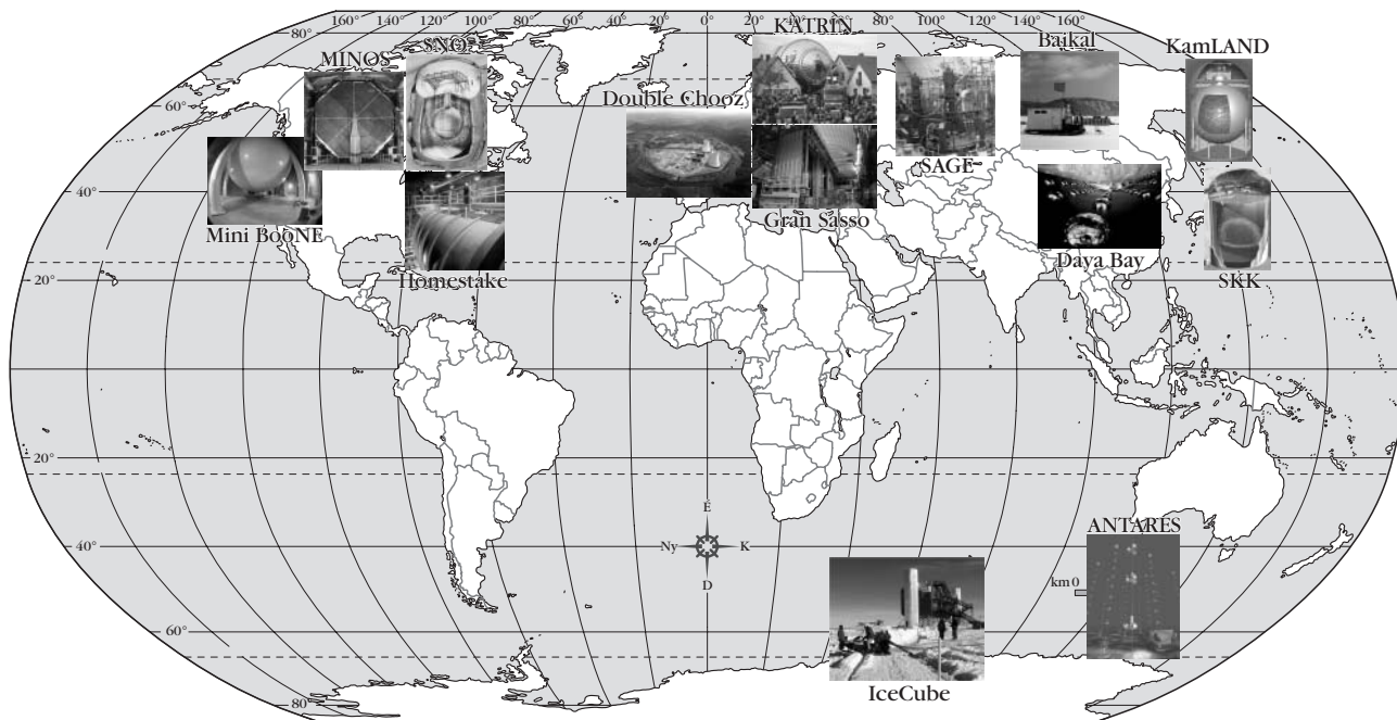
1. ábra. Neutrínókísérletek bányában, alagútban, víz és jég alatt, reaktorok közelében. A föld vagy vízréteg csökkenti a légkörből és a Naptól jövő töltött részecskék hatását, a víz vagy jég egyben észlelőközegként szolgál Cserenkov-sugárzás segítségével.
