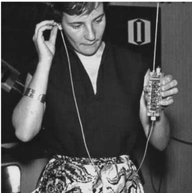
18. ábra. Az 1953-as düsseldorfi rádió-kiállításon bemutatott négy tús transzistronot tartalmazó rádió.
