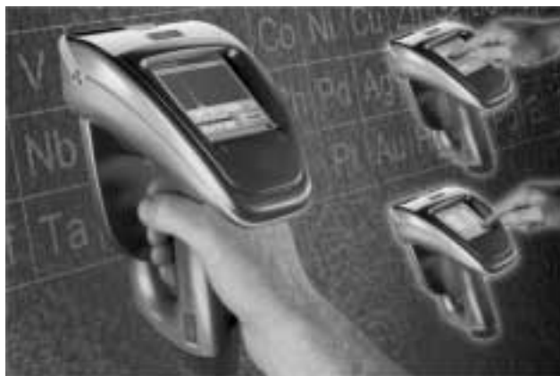
4. ábra. Szén nanocső téremissziós elektronforrással működő hordozható röntgenspektrométer
