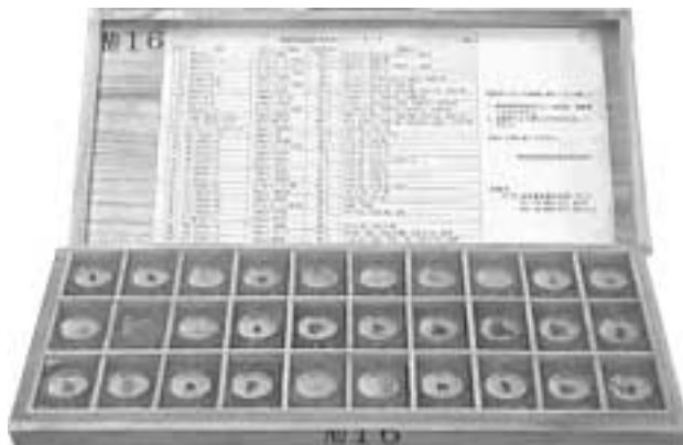
5. ábra. Az antarktisz meteoritok közetgyűjtemény vékonycsiszolatai a National Institute of Polar Research (NIPR, Japán Nemzeti Sarkkutató Intézet) készlete alapján sok érdekes összehasonlító szöveti vizsgálatot végezhetünk el.
