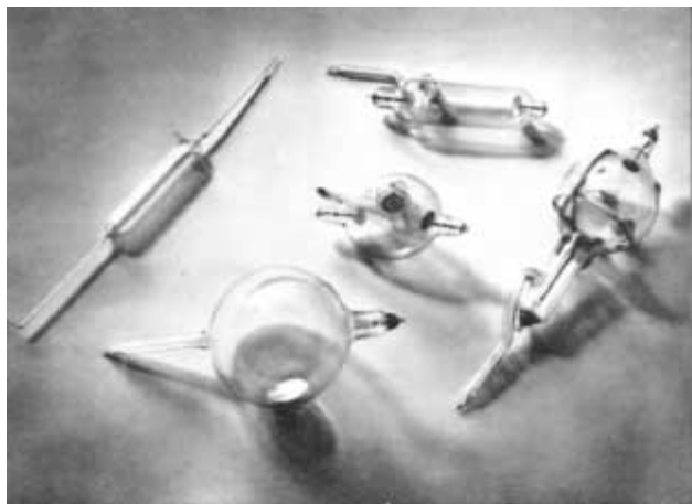
2. ábra. Röntgensövek, amelyekkel Röntgen dolgozott [14]
