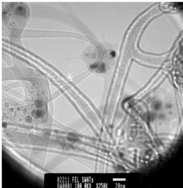
2. ábra. Nanocsövek HRTEM képe
