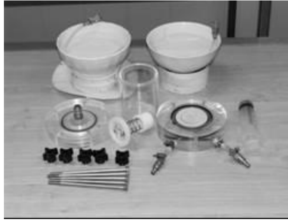
5. ábra A feszültségkamrás készülék
