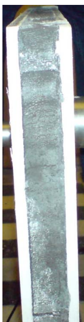
2. kép A dermesztett teherhordó homokbeton héjszerkezet
