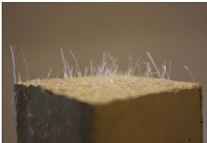
12. kép Szálerősített beton törésképe
