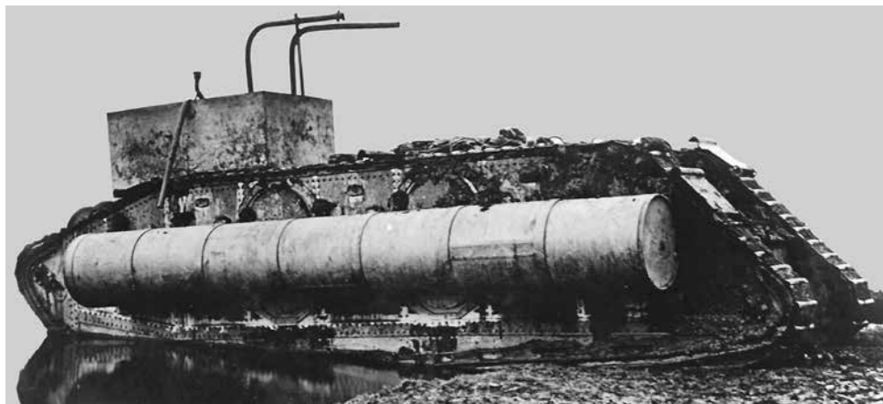
1. kép: Az első úszóképes lánctalpas harcjármű: a brit Mk. IX „Duck” (IWM, Q 14624)
