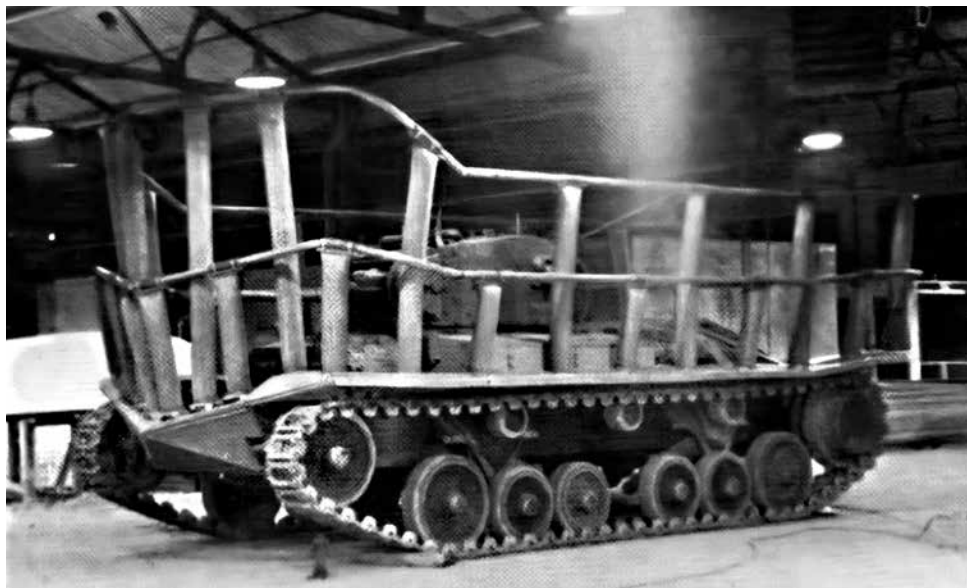
14. kép: A Valentine DD ponyvájának tartóváza (Bovington)
