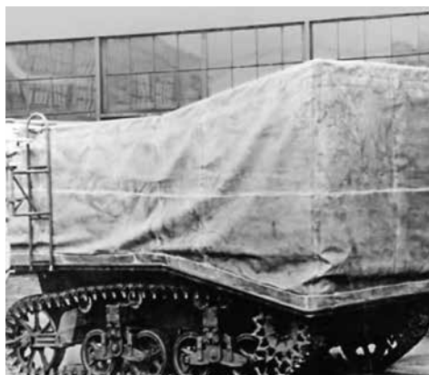
18. kép: Az M3E4 Stuart úszó könnyű harckocsi felhúzott ponyvával, illetve csupasz ponyvamerevítővel (NARA)
