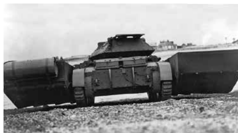
7. kép: Egy Series 3 pontonokkal úszóképessé alakított Covenant hátul- és oldalnézete (Bovington)
