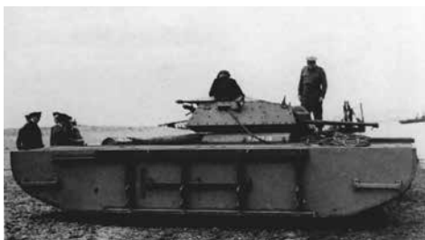
7. kép: Egy Series 3 pontonokkal úszóképessé alakított Covenant hátul- és oldalnézete (Bovington)
