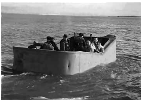
16. kép: Egy Valentine DD angliai próbái során behajtott a tengerbe (IWM, ADM 981)
