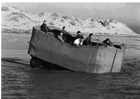
16. kép: Egy Valentine DD angliai próbái során behajtott a tengerbe (IWM, ADM 981)
