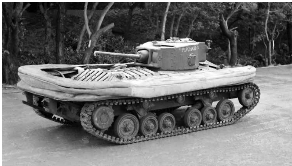
17. kép: Egy Valentine V DD leeresztett ponyvával a szárazföldön (IWM, H 35169). A harckocsi tornya hátrafelé néz, hogy a löveg ne akadályozza a ponyva felemelését.
