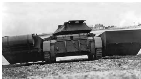
7. kép: Egy Series 3 pontonokkal úszóképessé alakított Covenant hátsó- és oldalnézete (Bovington)
